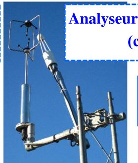
Analyseur rapide Licor-7500 (c'<sub>CO2</sub>, q'<sub>V</sub>)
